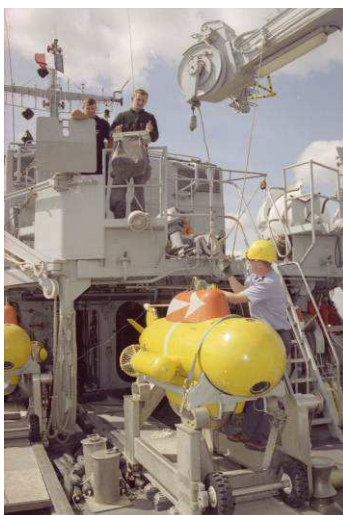
7 ♦ Référence : 01BST406LC-I-26. Treuillage du poisson autopropulsé (PAP) pour sa mise à l'eau. Lieu inconnu, septembre 2001. Photographe : Monot, Alain / ECPAD / collection « CPAR de Brest ».
