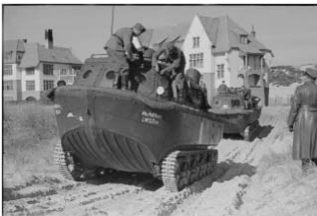
Référence : DAM 268 L01 / Légende : Essais de deux prototypes de véhicules amphibies de type Land-Wasser-Schlepper (LWS), sur une plage, sous la surveillance d'officiers de la Kriegsmarine et de la Heer. /Date : Été 1940 / Reporter : Inconnu
